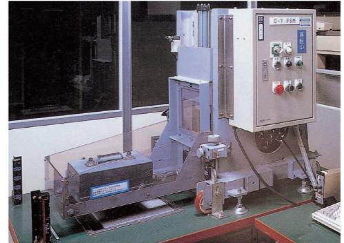
●すべり試験は、人間工学に基づいて開発された東工大式すべり試験機を用いて評価しています。
