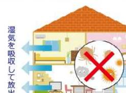
微細な連続気泡セルが湿気を吸収して放出。内部結露の発生を抑え、カビやダニの繁殖、木材の腐食から住まいを守ります。壁が水分を含んで垂れ下がる心配もありません。
