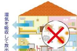
微細な連続気泡セルが湿気を吸収して放出。内部結露の発生を抑え、カビやダニの繁殖、木材の腐食から住まいを守ります。壁が水分を含んで垂れ下がる心配もありません。
